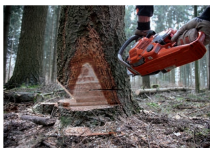
Durchtrennen des Haltebandes bei der Fällung eines Vorhängers. Fotos: SVLFG
