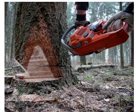
Die Sicherheitsfälltechnik bietet viele Vorteile und ist oftmals die Fälltechnik der Wahl. Foto: SVLFG
